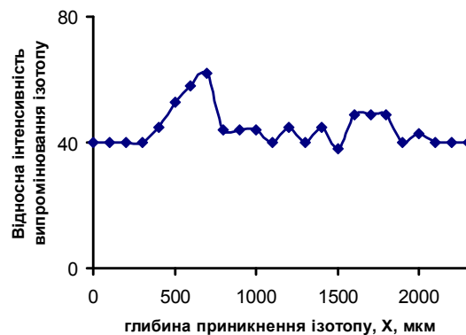
Рис. 6. Концентраційна крива розподілу радіоактивного ізотопу по перерізу 2 (рис.4, центр зварного з'єднання ).
