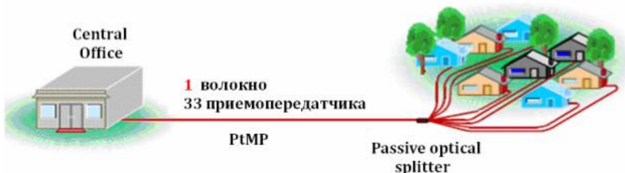
Рис.3 Топологія точка-багатоточка (PtMP), яка використовує деревоподібну мережу без активних вузлів (пасивна оптична мережа PON)
