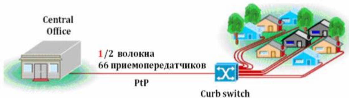
Рис.2 Топологія точка-точка із застосуванням Ethernet-комутаторів.
